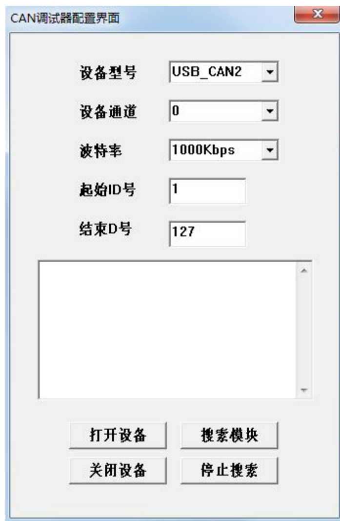
图 3.2 主机通信参数设置示意图
