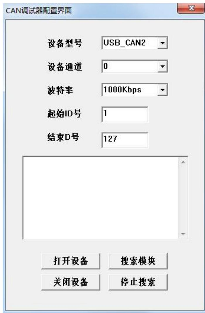
图 3.2 主机通信参数设置示意图
