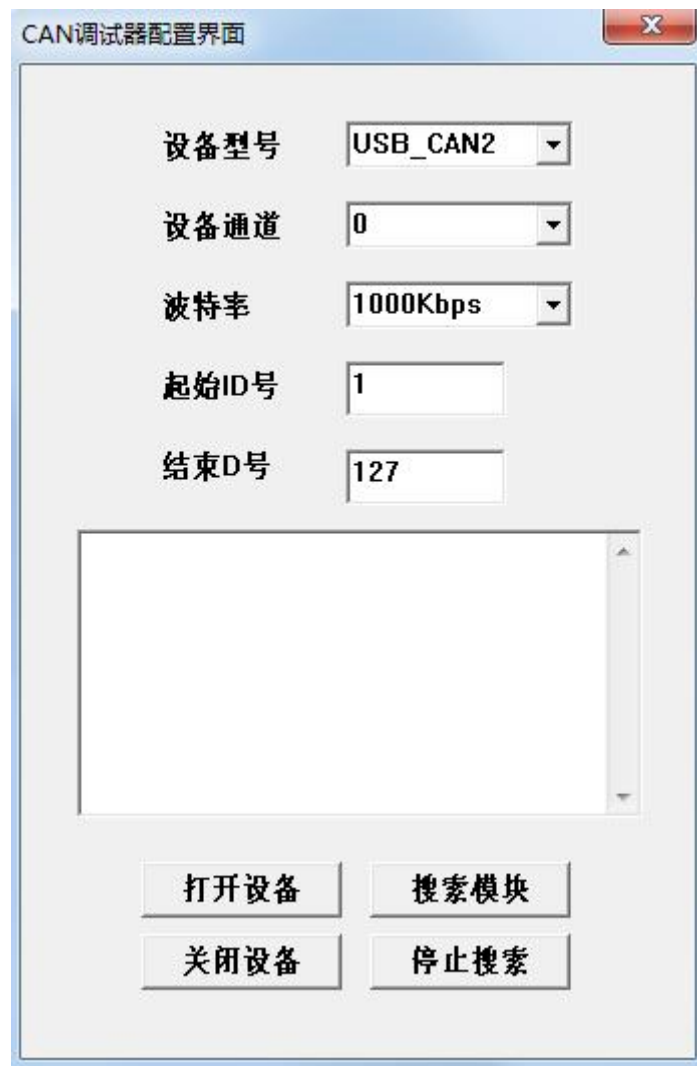
图 3.2 主机通信参数设置示意图
