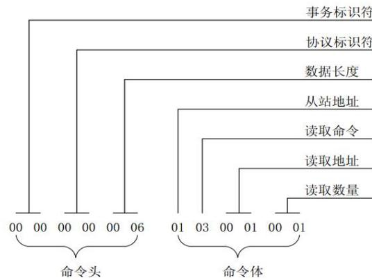
图 5.1 Modbus/TCP 请求命令结构
