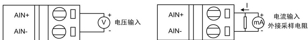
图 2.2 模拟量输入接线方式
