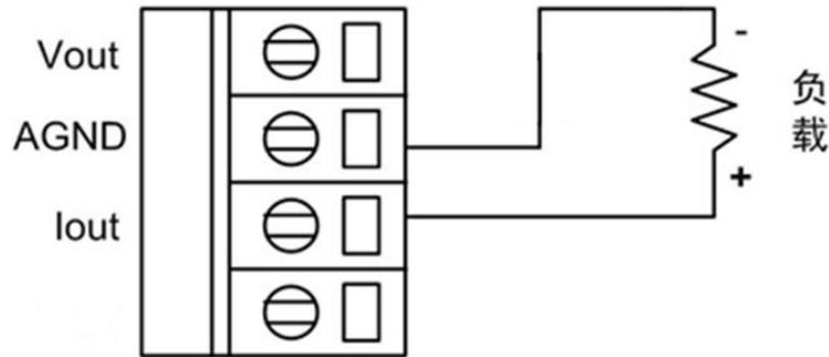
图 2.3 模拟量输出电流方式接线示意图
