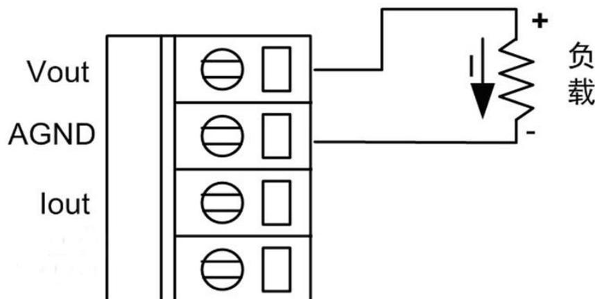
图 2.2 模拟量输出电压方式接线示意图
