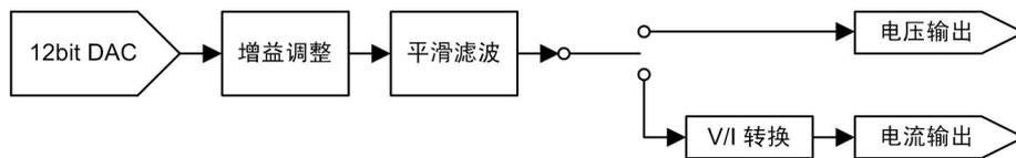
图 2.1 模拟量输出后端调理电路
