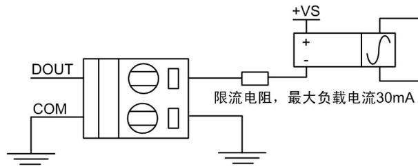
图 2.5 DO 驱动继电器接线示意图
