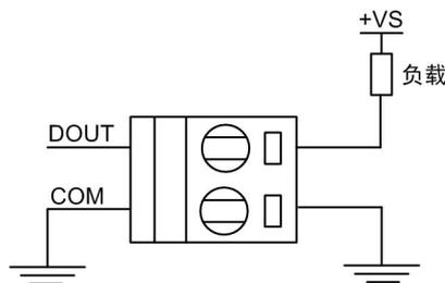
图 2.4 DO 接线方式示意图
