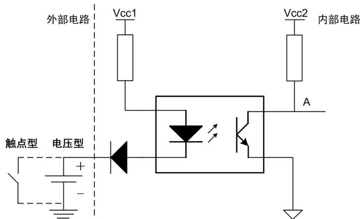
图 2.1 数字量输入原理示意图
