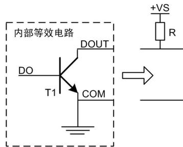
图 2.3 DO 输出内部等效电路
