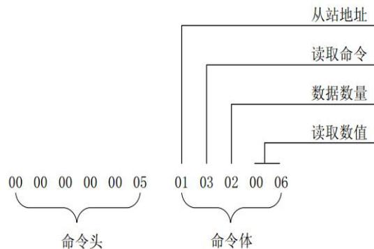
图 4.2 Modbus/TCP 响应帧结构
