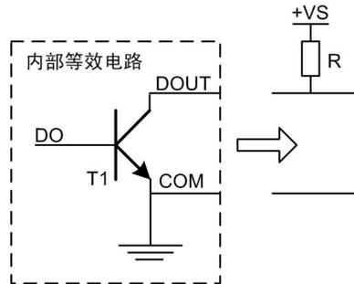
图 3.1 DO 输出内部等效电路
