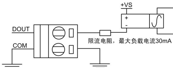
图 3.3 DO 驱动继电器接线示意图
