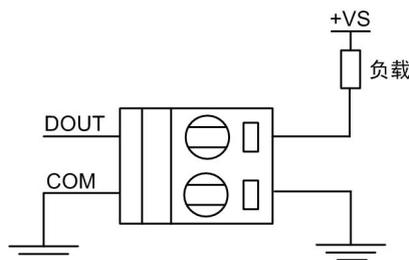
图 3.2 DO 接线方式示意图
