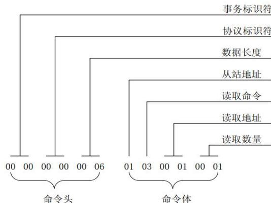
图 5.1 Modbus/TCP 请求命令结构
