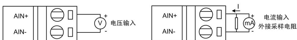
图 2.2 模拟量输入接线方式
