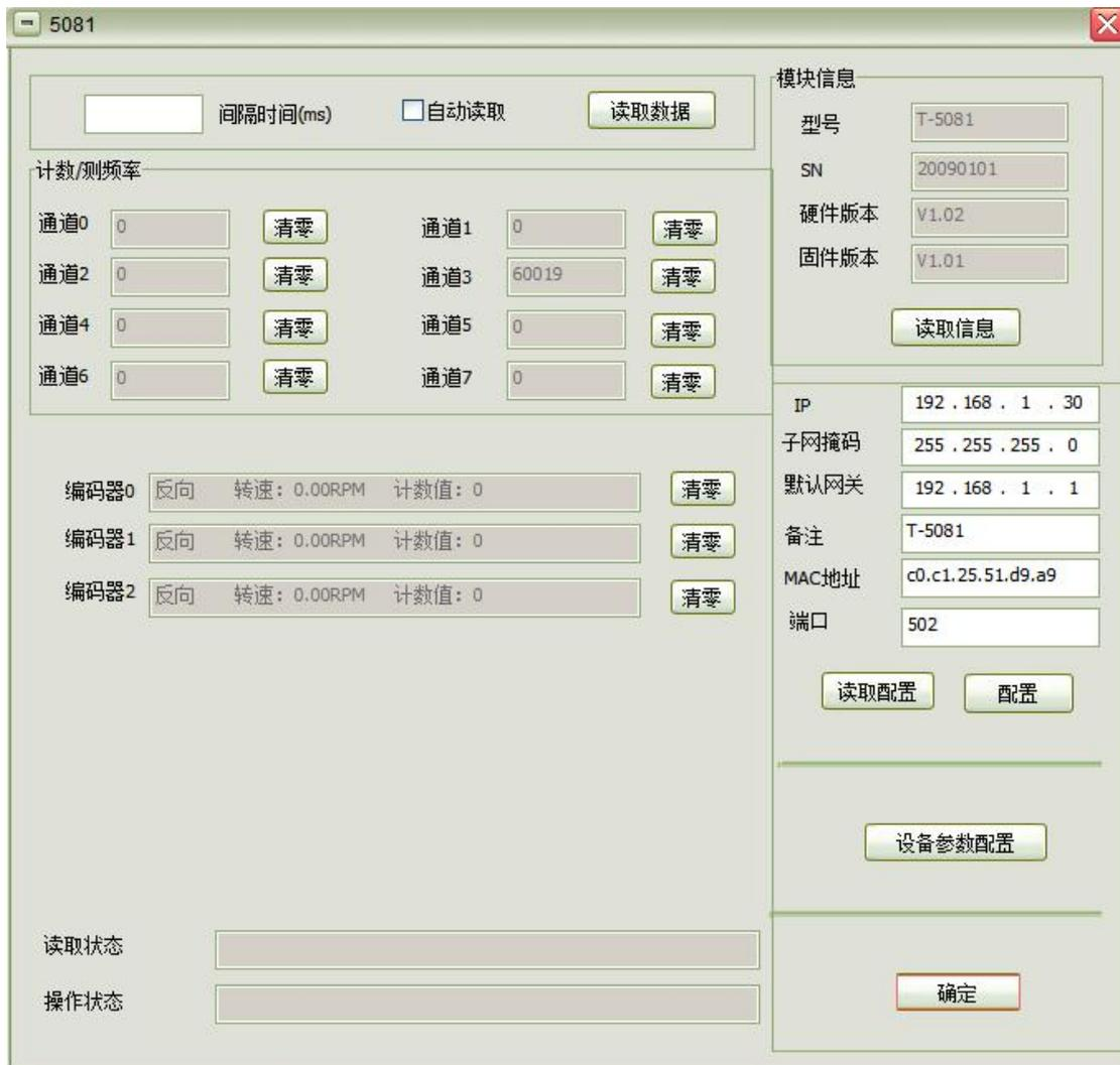
图 4.3 主机通信参数设置示意图
